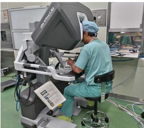
コンソールで操作する術者です。モニターの画面をのぞき込んで術野を確認し、手足で操作装置を操り、遠隔でロボット手術を行います。
