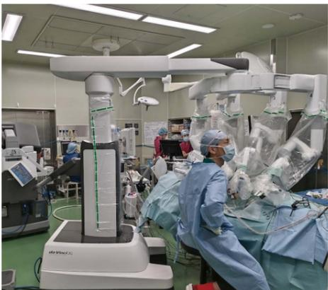
ロボット支援手術の様子です。写真中央の支柱からロボットの操作アームが右側に伸びており、患者さん側にロボットが配置されます。助手の先生が手術の進行を補助します。術者は、写真左側奥のコンソールに座って遠隔操作で手術を行います。
