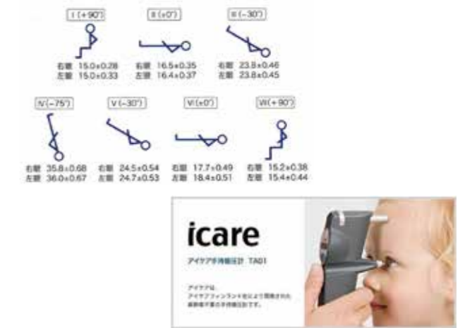
図5 / Icare rebound tonometer Icareは、測定時痛みもなく簡便な機械で、小児の眼圧測定にも活用されます。また、座位だけでなく、様々なアプローチにて眼圧測定できるため、体位変動による眼圧変化を捉えることができます
