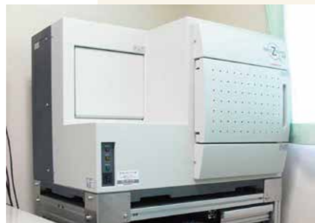
バーチャルスライドスキャナ(浜松ホトニクス社製 Nano Zoomer-XR)
